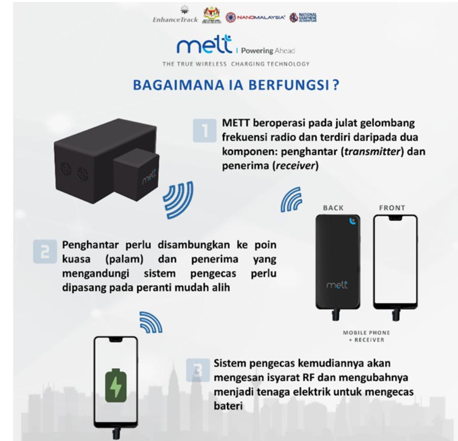
METT beroperasi pada julat gelombang frekuensi radio dan terdiri daripada dua komponen: penghantar dan penerima. Penghantar perlu disambungkan ke poin kuasa (palam) dan penerima yang mengandungi sistem pengecas perlu dipasang pada peranti mudah alih.
